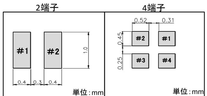
備考: 回路基板設計の際は、水晶振動子搭載部(下面)に回路パターンを設けないでください。
